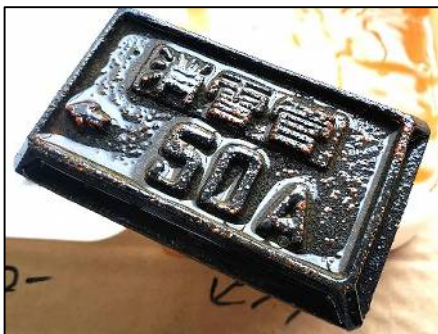
タール塗装仕様…1週間後（発錆有り）
